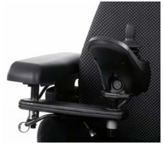
Mecanismo encapsulado para abatir el mando // QZT110056
