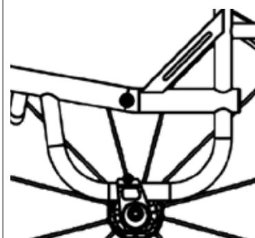
Châssis arrière rond centre de gravité réglable
