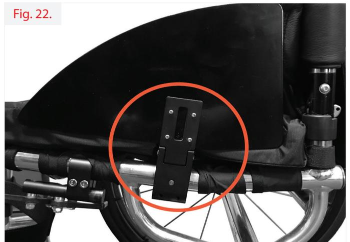
retire los 4 tornillos del interior del protector lateral. Para la instalación, asegure todos los tornillos pero no los ajuste hasta que todos estén en posición. Procure no colocar los tornillos de manera incorrecta.
