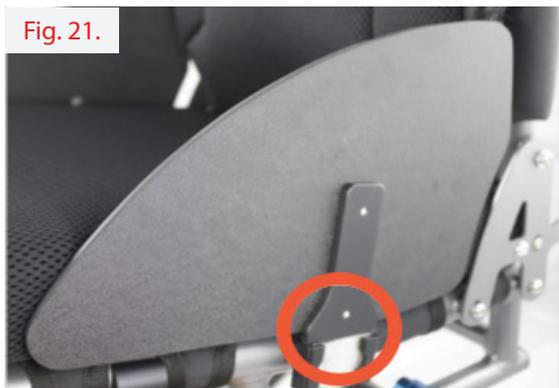
Retire los protectores laterales del receptor. Con una llave Allen de 4 mm del juego de herramientas, afloje los 2 tornillos que fijan el protector lateral al tubo. Para instalarlo, vuelva a colocar los 2 tornillos y ajústelos. Procure no colocar los tornillos de manera incorrecta.
