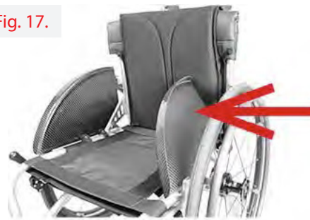
Passo 2: Empurre a proteção lateral esquerda
