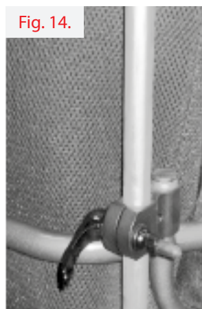
Poignées de poussée réglables en hauteur
