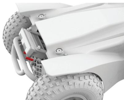
Figure 4.6a Bremshebel des Extreme X8 – betätigt
