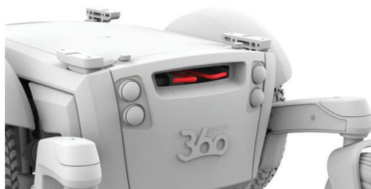
Figure 4.4a Bremshebel des Magic 360 – betätigt
