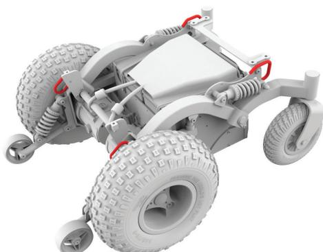
Figure 5.2c Hebepunkte am Frontier V4
