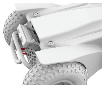
Figure 4.6b Bremshebel des Frontier X8 – gelöst
