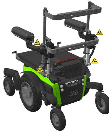
Figure 4.3a Roter Entriegelungsgriff für das Abklappen nach vorne
