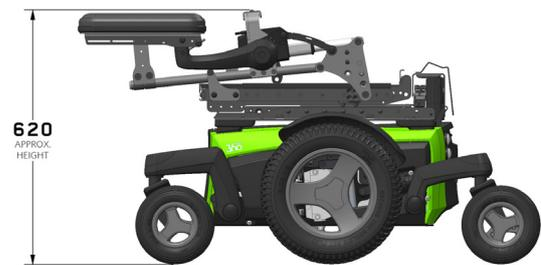
Figure 4.3b Magic 360 Höhe mit abgeklappter Rückenlehne
