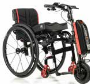
Aandrijfwiel 8,5", massieve band, voor koppeling met vastframe rolstoelen.
