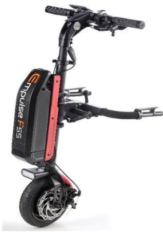
EMF070085: Aandrijfwiel 8,5", massieve band (afgebeeld met bevestiging voor rolstoelen met vast voorframe (EMF010027) en rode kleuraccenten)
