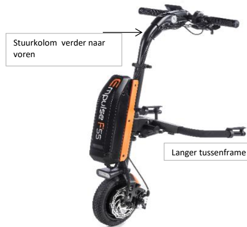
EMF070085: aandrijfwiel 8,5", massieve band (afgebeeld met bevestiging voor rolstoelen met wegzwenkbare beensteunen (EMF010028) en oranje kleuraccenten)
