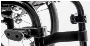
EMF010029: Bevestigingsklemmen voor rolstoelen met een ronde buis (geschikt voor buisdiameters 19,5 mm, 23 mm, 28,6 mm en 30 mm). Aanpasbaar d.m.v. meegeleverde verloopstukken.
