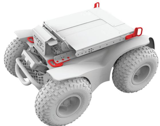
Figure 5.4d Verankerungspunkte am Extreme X8
