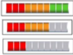
Wenn auf der Batterieanzeige rot, gelb und grün angezeigt werden, werden die Batterien aufgeladen.
