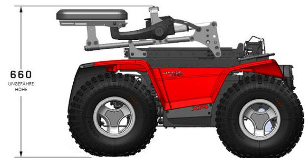
Figure 4.3f XT4 Höhe mit abgeklappter Rückenlehne
