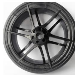
**// Ruedas con llanta de carbono (NTR080060):** llanta ligera, fabricada en carbono-composite (-80 gramos menos en comparación con las ruedas con llanta de aluminio)
