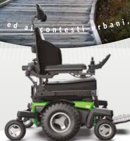
Versione Crossover: ruote motrici da 14" per ancora maggiore comfort grazie alle sospensioni maggiorate (larghezza totale da 635mm)
