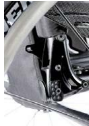
// NTR030015 Schienale abbattibile, regolabile in angolazione, a blocco singolo.
