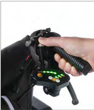
Alt styres fra konsollet som festes på kjørehåndtaket - av/på, hastighet og kjøring.
