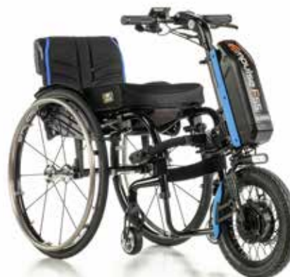
Hjul 14", luftdäck, dockning för manuella rullstolar med fast front.
