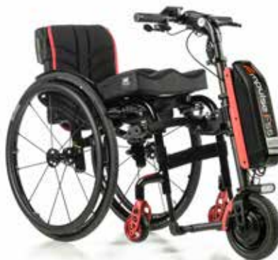
Hjul 8,5", massivt däck, dockning för manuella rullstolar med fast front.
