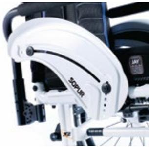
// NTR040103 Spondine diritte in alluminio con bordo avvolgente (nel colore del telaio)
