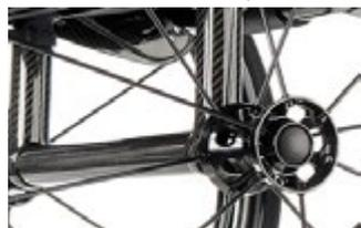
// **Asse ruote posteriori (NTR010403):** incollato al tubo dell'asse, non è possibile effettuare ulteriori regolazioni (-160 g rispetto all'asse ruote posteriori in carbonio NTR010402) (disponibile solo con campanatura a 0°)
