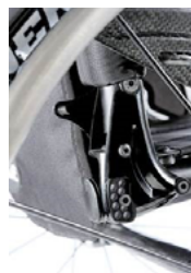
// NTR030015 Oparcie z regulacją kąta, składane
