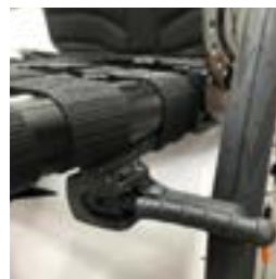
// NTR060024 Kompaktbremse EVO, Leichtgewicht
