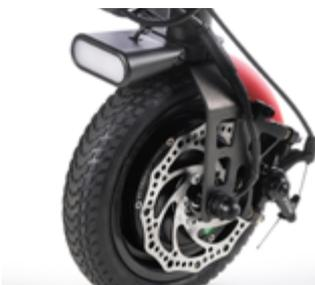
Luce a LED, parafrangente (con rifinitura di colore rosso) e freno a disco (in foto applicati su EMF070085 versione con ruota da 8,5" piena)
