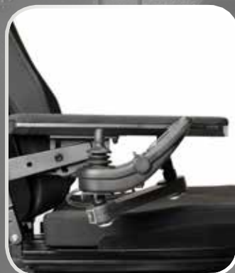
OPKLAPPELIGE ARMLÆN samt styreboks som kan svinges tilbage giver enkel indkøring og positionering
