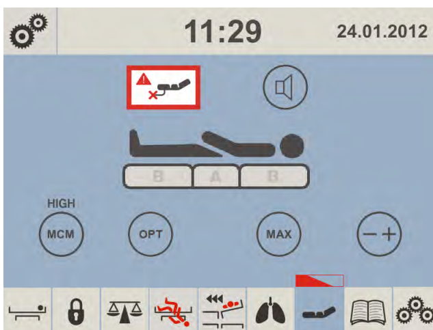
Fig. Varsel – Frakoblede luftslange
