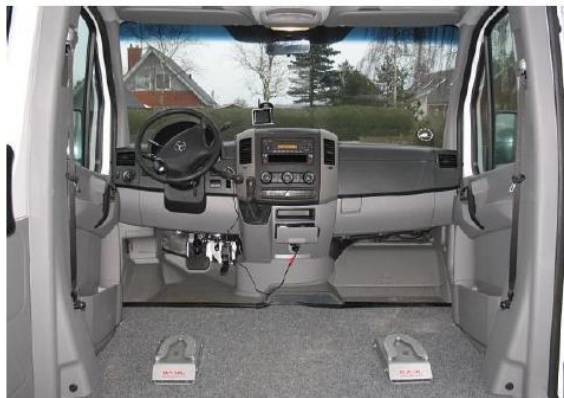
Dahl dockningsstation monterad på golvet
