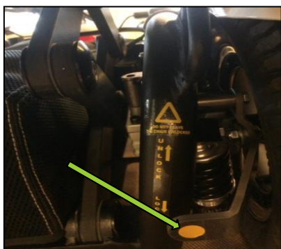
Frikoppling av drivmotorer
