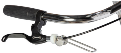
Fig. 1 Parkeringsbremsehendel Flytt denne hendelen for å koble parkeringsbremsen inn/ut
