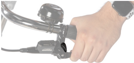
Fig. 2: Parkeringsbremsebryter Trekk i håndtaket og vri på bryteren for å koble parkeringsbremsen inn/ut
