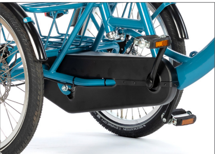
Lukket kjedekasse med automatisk kjedestrammer gir økt sikkerhet, økt holdbarhet og mindre vedlikehold.
