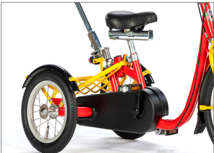
Ledsagerstyringen gir et godt grep for ledsager og er laget slik at sykkelen beholder bakkeklaringen.
