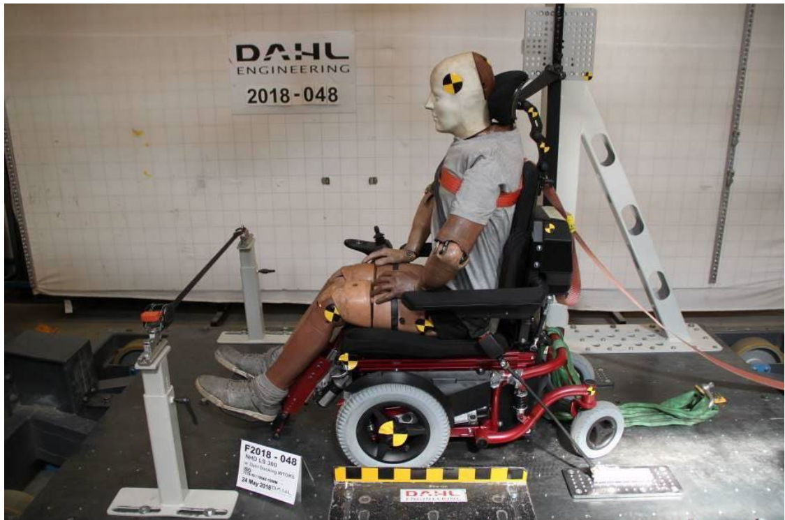
LS-300 krasjetest med Dahl dokkingstasjon.
