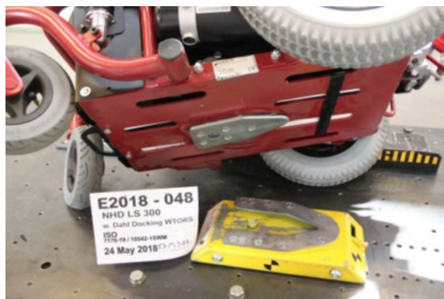
LS-300 rullestol med Dahl dokkingplate montert
