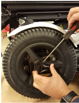
Fjern dekslet med en flat skrutrekker
