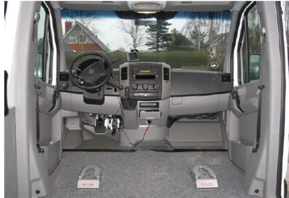
Dahl dokking montert i gulvet til en bil
