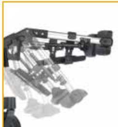
Beensteunen lengte compenserend, wegzwenkbaar. Onderbeenlengte 350 - 510 mm. Kniehoek 0 - 70°.
