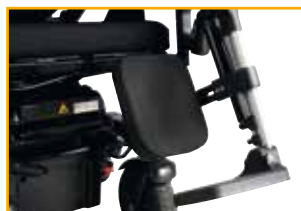
Kuitsteunen, gepolsterd, diepte instelbaar Breedte: 180 mm Hoogte: 230 mm Diepte: 35 mm
