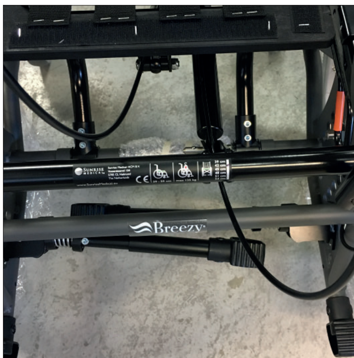
6. Gjenta prosedyren med demontering og montering på motsatt hendel. Påse at vaierne ligger som vist på bildene.
