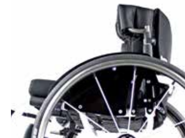
Integrované nastavitelné boční opěry. Posílená stabilita pro uživatele, kteří vyžadují větší boční podporu než poskytuje standardní zádová opěrka
