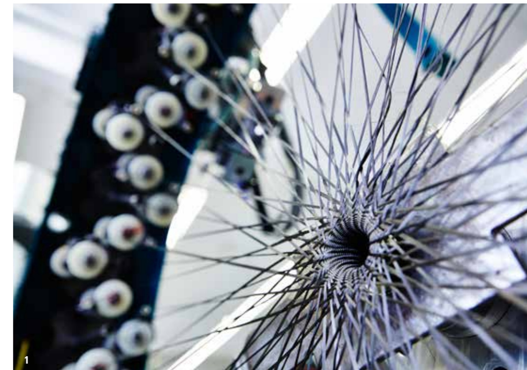
1 Robotické zaplétání karbonových trubek - budoucího rámu vozíku KRYPTON
