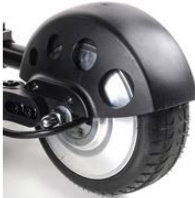
**Nota:** Al mover hacia atrás la silla con el dispositivo apagado, las luces de la unidad de control parpadearán (no significa fallo ni advertencia; el motor funciona como un alternador)
