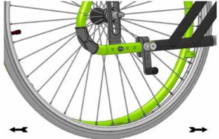
Richten Sie die beiden Klemmen (B-C) rechts und links so zueinander aus, dass beide Klemmen sich auf gleicher Höhe befinden. Verwenden Sie dazu einen Bezugspunkt von dem aus Sie messen können (z.B. von der Lochplatte des Rollstuhls zur Klemme). Wenn nötig lösen sie die Schrauben (3) wieder etwas und verschieben Sie beide Klemmen (B-C) so dass sie auf einer Ebene sitzen. Danach legen Sie die Schrauben (3) wieder leicht an.
