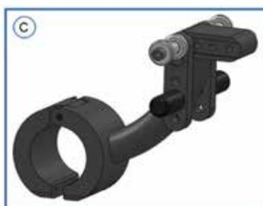
Legen Sie die Klemme (A) um das untere Rahmenrohr und verschrauben beide Teile mit den Schrauben (1). Die Schrauben (1) nur leicht anziehen, so dass sich die Klemme (A) noch drehen und verschieben lässt. Richten Sie jetzt die Klemme so aus, dass sie exakt in der Mitte sitzt und die Leiste (B) vertikal zum Boden steht. Ziehen Sie jetzt die Schrauben fest (Drehmoment: 5 Nm).
