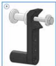
Suchen Sie eine freie Bohrung am unteren Rahmenrohr. (Wie im Bild unten gezeigt, kann auch eine bereits vorhandene Verschraubungsbohrung für den Anbau verwendet werden) Ziel sollte es sein den Halter so weit wie möglich nach vorne zu bringen (z.B. bei Stühlen mit Kreuzstreben direkt hinter der Kreuzstrebe).
