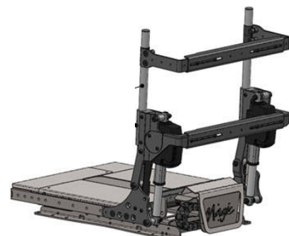
Respaldo con inclinación eléctrica anti-fricción 0° a 155°
