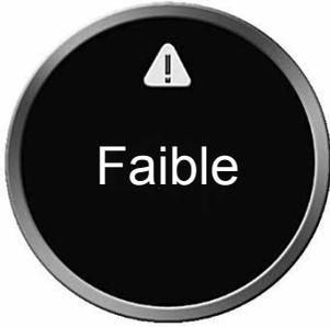
Ce message s'affiche en cas de déconnexion d'un contacteur Utilisateur et si le module OMNI2 est programmé pour continuer à avancer à vitesse réduite.
