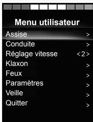
L'activation vers l'avant et l'arrière de l'unité de commande permet de changer la ligne sélectionnée dans le menu. Il est également possible de programmer une séquence de balayage automatique, laquelle met tour à tour chaque ligne en surbrillance. Demandez conseil au professionnel de santé ou au service après-vente.
