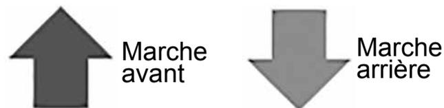
Ces symboles ne sont visibles que si le module OMNI2 a été configuré pour fonctionner avec une unité de commande spéciale proportionnelle à trois axes. Reportez-vous à la section Fonctionnement avec des unités de commande spéciales de type contacteur proportionnel à 3 axes (Section 3.6).
