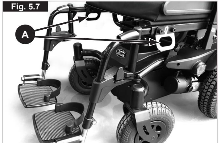
Positionnement du système d'arrimage avant, (Fig. 5.7 - A).
