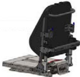
Dossier électrique 0° - 160° Structure dossier Rehab Rabattable
