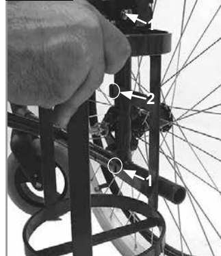
SUPPORT BOUTEILLE Charge maximum : 5 kg
