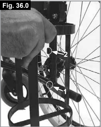
HALTERUNG FÜR SAUERSTOFFFLASCHEN Maximale Zuladung: 5 kg
