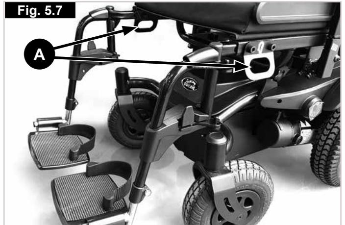
Ubicación de la correa de sujeción delantera (Fig. 5.7 - A).
