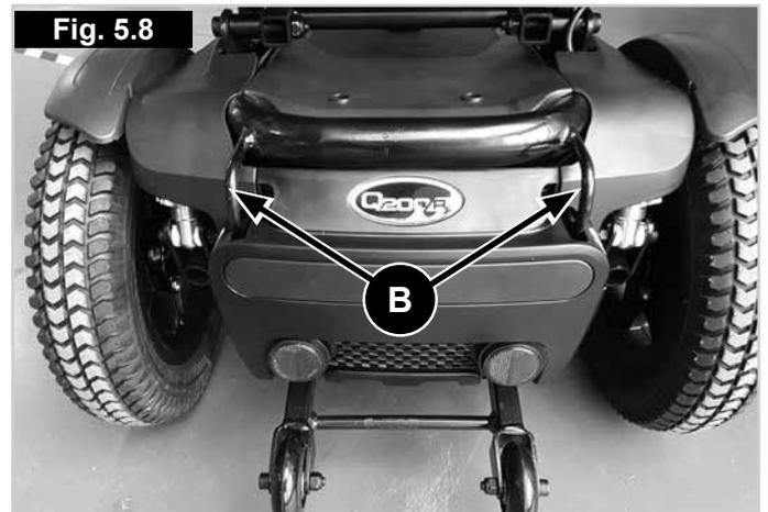
Ubicación de la etiqueta de la correa de sujeción trasera y anclaje, (Fig. 5.8 - B).
