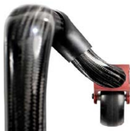
KRR010301 Ângulo standard do tubo da forqueta, mais aberto e posição da roda adiantada
