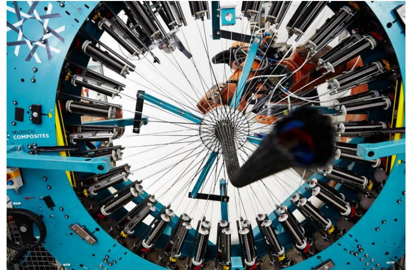
Trenzado con robots KUKA
