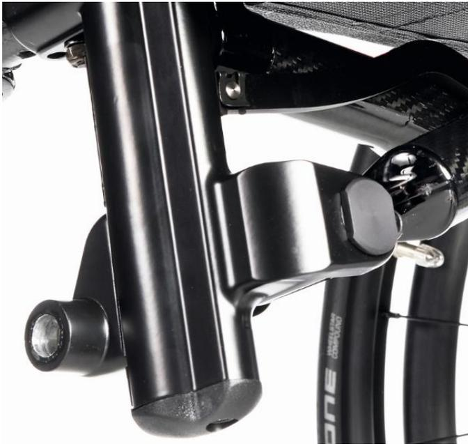
Pletina del eje corta, permite +1cm ajuste altura asiento
