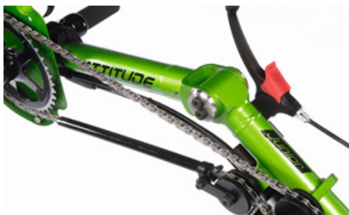
Forqueta ajustável em ângulo e profundidade
