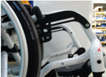
Travão std com placa não compatível com fixação superior Attitude
