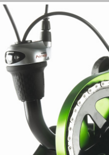
Comando de mudanças Grip-shift montado na estrutura
