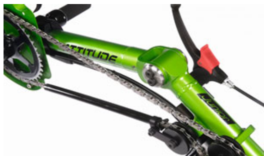
Horquilla ajustable en ángulo y profundidad
