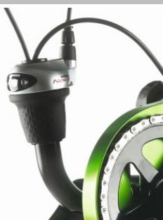
Mando de cambio Grip-shift montado en el armazón
