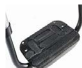
KRR050026 Pedana unica regolabile in angolazione e profondità, in carbonio
