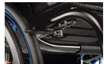
KRR060004 Freno a forbice compatto superleggero
