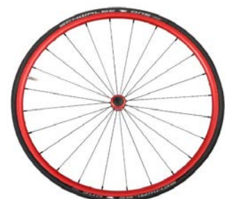
KRR100338 Superleggera a 24 raggi neri dritti con cerchio/mozzo in colore anodizzato rosso
