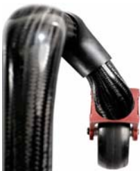
KRR010302 Ángulo más cerrado del tubo de la horquilla, y posición de la rueda retrasada
