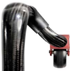
KRR010301 Ángulo standard del tubo de la horquilla, más abierto, y posición de la rueda adelantada
