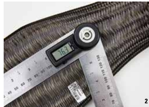
1 De carbonframebuizen worden ontwikkeld op basis van een gerobotiseerde vlechttechnologie
