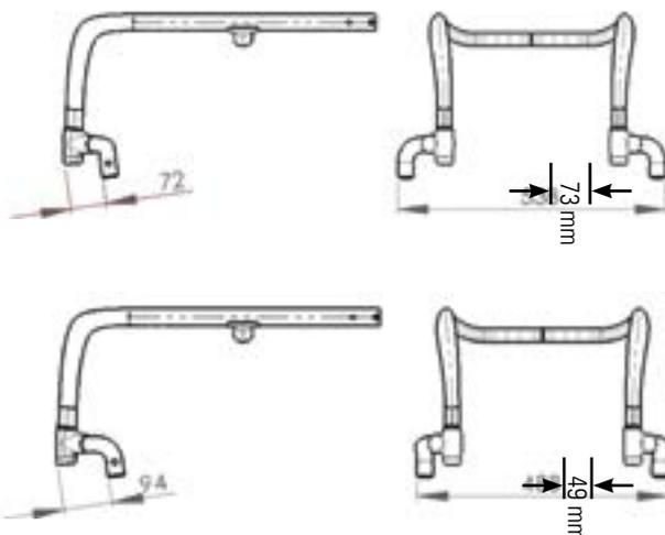
Schmalere (-24 mm pro Seite), nach hinten gerichtete (+22 mm) Position der Lenkräder für kompaktere Abmessungen und verbesserte Manövrierfähigkeit. Geringere Frontstabilität ggü. Lenkradanbindung weit- wir empfehlen diese Option nur in Kombination mit Sitzwinkeln > 40 mm (Unterschied vordere/ hintere Sitzhöhe) oder Sitztiefen über 420 mm.
