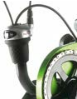
// ATT070043 Drehgriffschalter am Rahmen montiert
