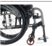
// TELAIO ANTERIORE SWING AWAY ATTIVO CON ANGOLO PEDANA A 90°
