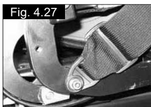
Placez une rondelle contre le boulon. Insérez le boulon à travers la barre de fixation de la sangle sous-abdominale. Placez l'autre rondelle contre le boulon, (Fig. 4.28).
