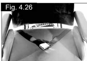
Faites passer les extrémités de la sangle sous la barre transversale du dossier, comme illustré, à l'aide de l'orifice de fixation inférieur. Les boucles de réglage doivent être faciles d'accès et la sangle ne doit pas être entortillée, (Fig. 4.27).
