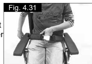
En général, la ceinture sous-abdominale doit être fixée de façon à ce que les sangles soient à un angle d'environ 45° (Fig. 4.32), et quand elle est correctement réglée, elle ne permet pas à l'utilisateur de glisser dans le siège.
