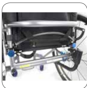
TGAXG020 HLTXG020 Schienale pieghevole a doppio blocco, regolabile in angolazione (si blocca in posizione aperta e in posizione chiusa) (Disponibile per Tiga e HiLite)
